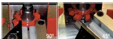
Morza de ángulo variable y escala graduada incorporada. Fresa perfiles de Aluminio y PVC a 90° y a 45°
